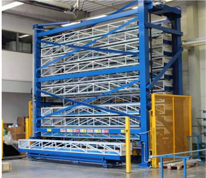
GMH Tower Schwerlastmaschinen sind für die Lagerung und das Handling von schwerem Lagergut konzipiert, insbesondere zur Lagerung von Metallhalbzeugen
