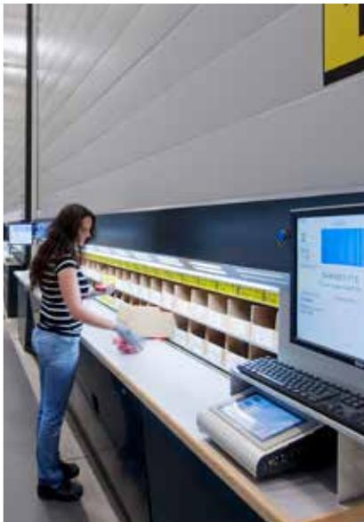
Der Industriepaternoster IPN hilft, Zeit und Geld zu sparen, da Kommissionierprozesse optimiert und gleichzeitig Fehler bei der Kommissionierung auf ein Minimum reduziert werden. Der Industriepaternoster benötigt bis zu 75% weniger Grundfläche als herkömmliche Lagerlösungen.
