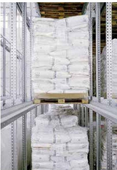
Das Paletten-Einfahrregal ist eine Form der kompakten Blocklagerung und eignet sich ideal zur Lagerung großer Mengen gleichartiger Güter mit geringer Umschlagshäufigkeit.
