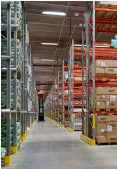
Das P90 Breitgang-Palettenregal bietet uneingeschränkten Zugriff auf alle Paletten. Breite und Tiefe richten sich nach den verwendeten Palettenformaten. Es kann in Einzel- und Doppelzeilen montiert werden.
