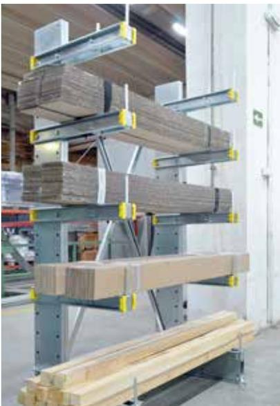
Leichtlast-Kragarmregale sind die ideale Lösung, wenn lange und sperrige Güter wie Stabmaterialien, Rohre, Leitungen oder Holzlatten gelagert werden sollen. Die Lagerung erfolgt horizontal, das Lagergut kann somit manuell oder mit dem Gabelstapler be- und entladen werden.
