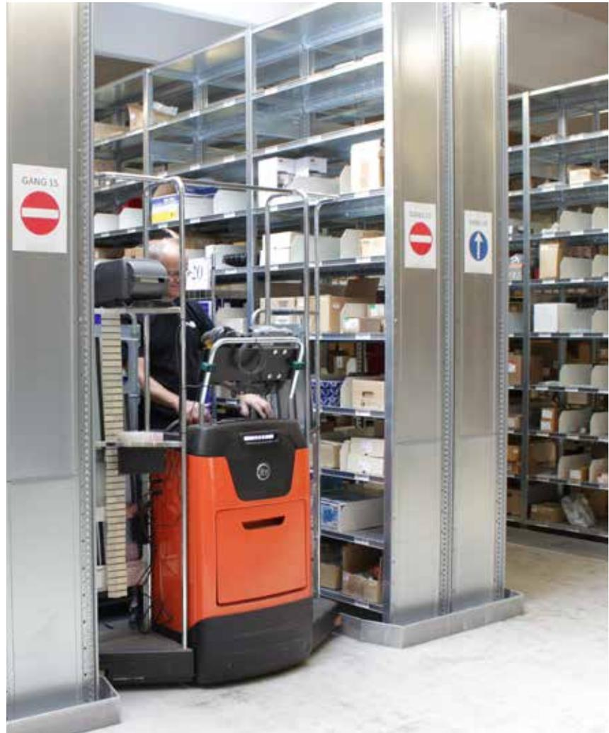
Schmalgang-Hochregale Hi280 werden häufig in Lagern mit 24-Stunden-Betrieb eingesetzt. Im Vergleich zum Gabelstaplerbetrieb werden im Schmalganglager Man-Up Fahrzeuge (Schmalgangstapler) oder Regalbediengeräte eingesetzt. Durch diese Lagerplatz-Optimierung wird insbesondere die Kommissionierleistung um ein Vielfaches verbessert.
