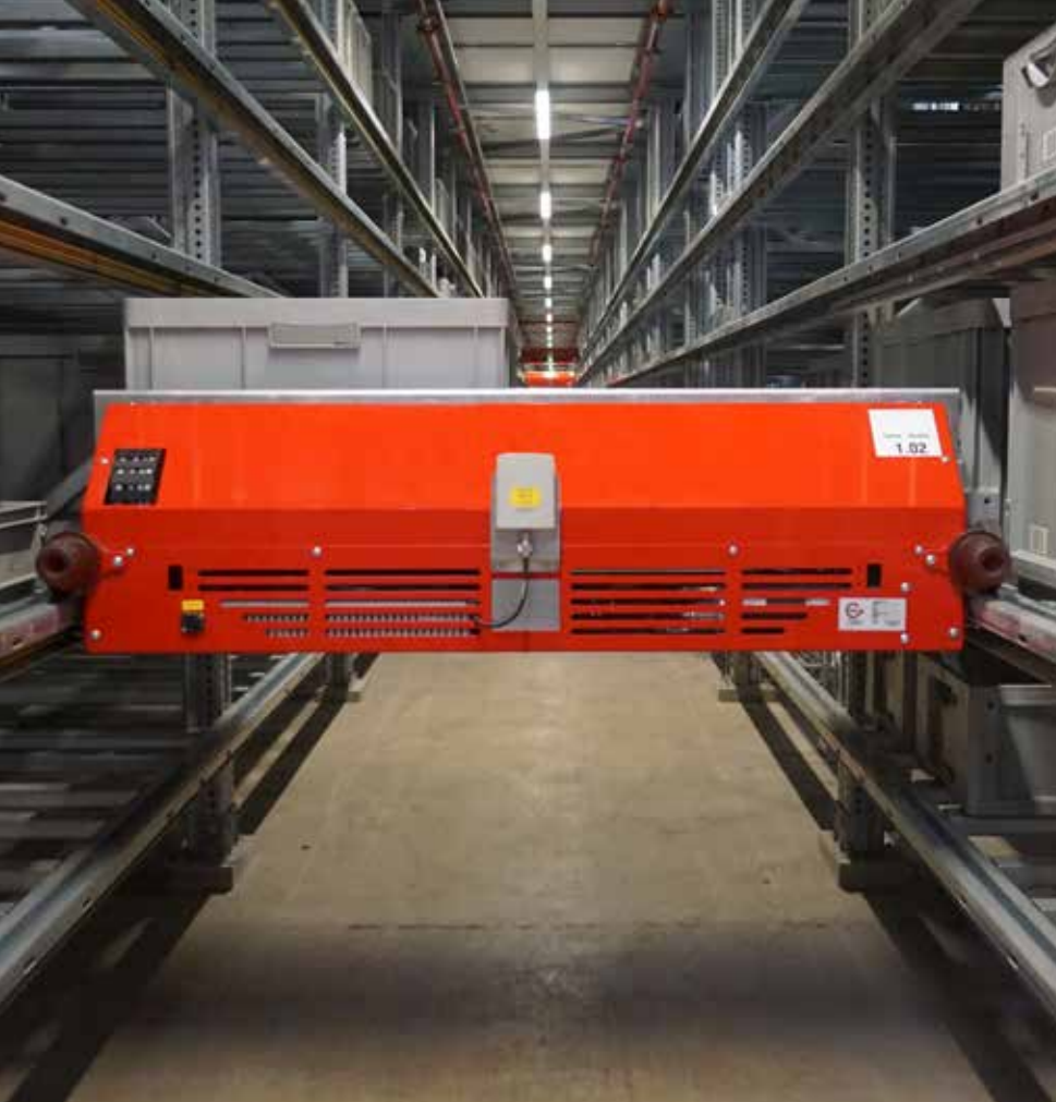
Automatisiertes Kleinteile Shuttle System – doppelt tief 19.800 Behälter - Lagerplätze
